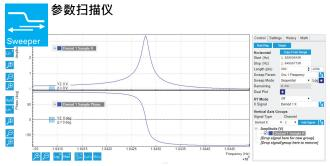
用户能够自由调整参数扫描仪的扫描步长,支持线性或对数方式,在指定范围内进行扫描,以实现自动化测量。而且可以对频率、偏置电压或测试信号幅值进行自动化扫描。各种应用模式可帮助用户以最佳设置进行测量,并在最短的测量时间内获得最精确的结果,而无需进行繁琐的手动调整。
