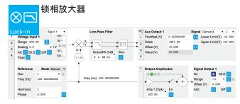
每个解调器都有示意框图,以便直观地了解仪器的配置。此外,通过单个面板上的概览选项卡即可控制所有解调器、信号输入和信号输出。
