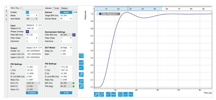
每一个 PID/PLL 控制器都有对应的配置页面。主控制器设置位于左侧, DUT 模型设置和自动调谐位于右侧,并可随时查看模型传递函数和阶跃响应。
