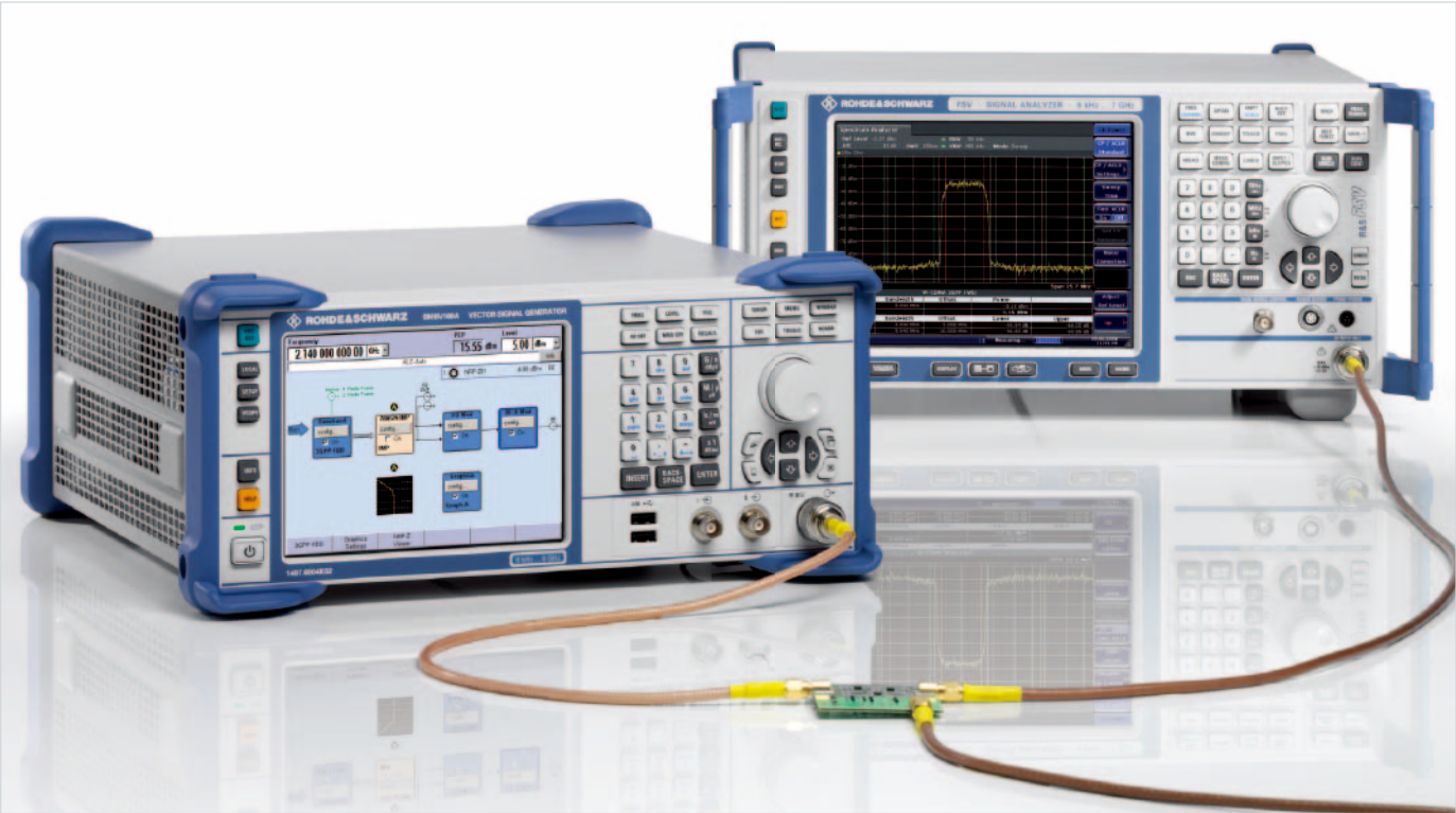
梦幻组合：使用R&S®SMBV100A和R&S®FSV 分别用于生成和分析数字调制信号
