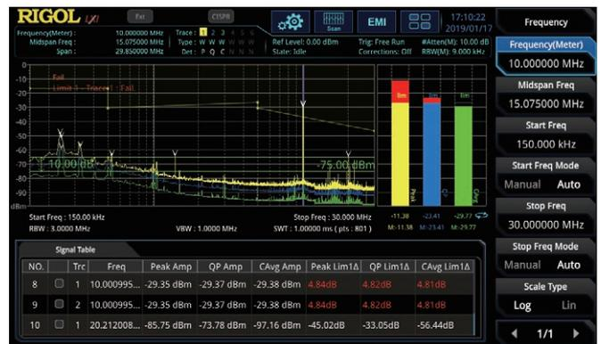
快速调用符合CISPR标准的限制线（如EN55011、EN55012等）进行预测试，并可使用三种不同检波器对目标点进行监测
