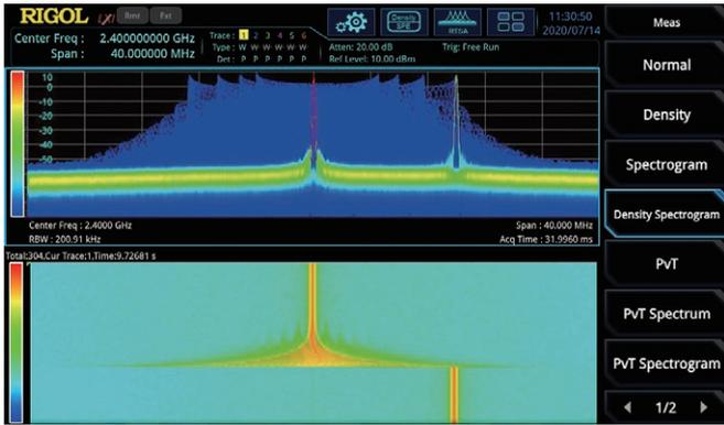
概率密度谱可直观的显示频率信号出现的频次
