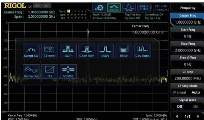
高级测量模式提供发射机测试规范要求的：通道功率、邻道泄露比、占用带宽等测试项目
