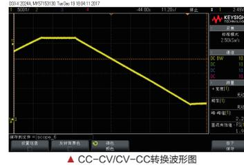
▲ CC-CV/CV-CC转换波形图
