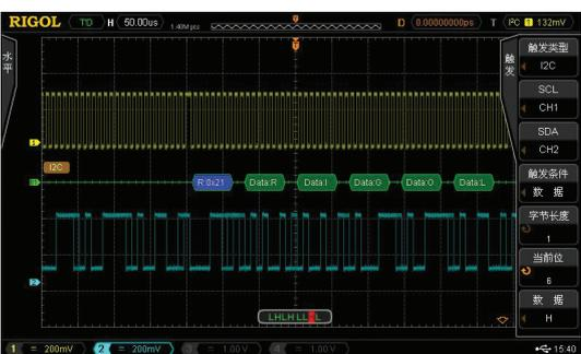
支持模拟和数字通道的串行总线触发和解码。
