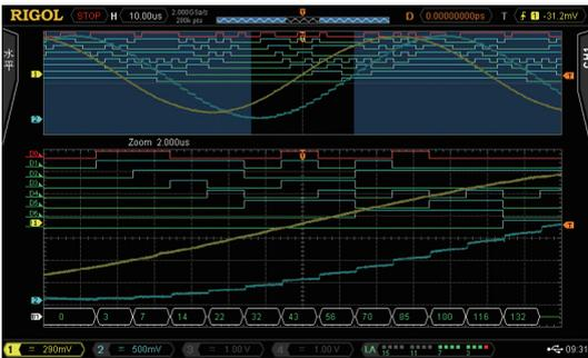
多达2+16或4+16个通道，模拟和数字通道间可相互触发，时间相关的模拟和数字通道波形显示和分析。
