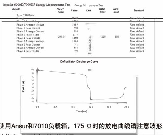
使用Ansur和7010负载箱, 175  $\Omega$ 时的放电曲线请注意波形、峰值电压和放电时间的差异
