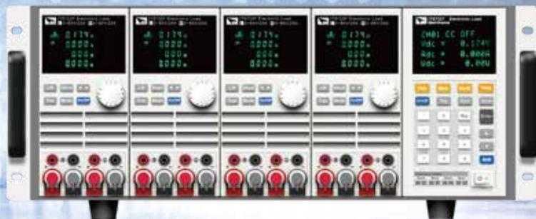
IT8700P系列多路输入可编程直流电子负载在IT8700的基础上进行了改良并升级，继承了原有可抽换式模块化的设计，单机框可达8个通道，扩展机框可达16通道。用户可根据需求在8款负载模组中自由选配。同时配备了前/后端子，更符合用户多样化的测试需求。
