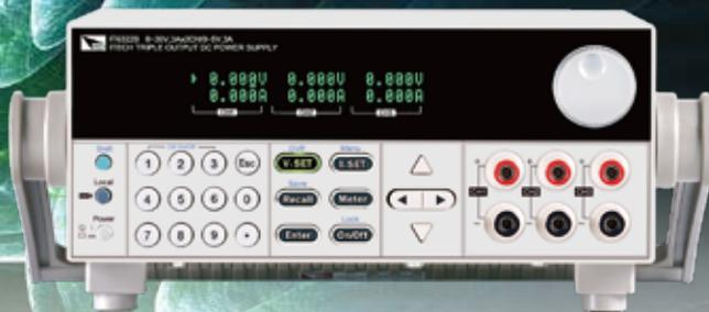
IT6300系列每路输出电压和电流均可设定为从零到最大额定输出值。提供了通道的串联、并联以及同步功能，可以给客户的测试带来多用途的解决方案。该系列具有最高可达1mV/1mA的高分辨率、高精度以及高稳定性的特征，并且配备了远端测量的功能，可以使测试更加精准。部分机型内置标准的USB/RS232通讯接口，大大提升了通讯速度，并且客户还可以利用光标调节数字步进值来方便操作。
