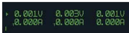
\*在设置状态，若再设置CH1的电压为2V，则CH2的电压会自动同步到4V(成比例)
