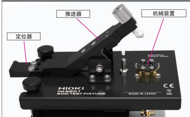
2. 将定位器拉出，推进器向被测物按下固定
