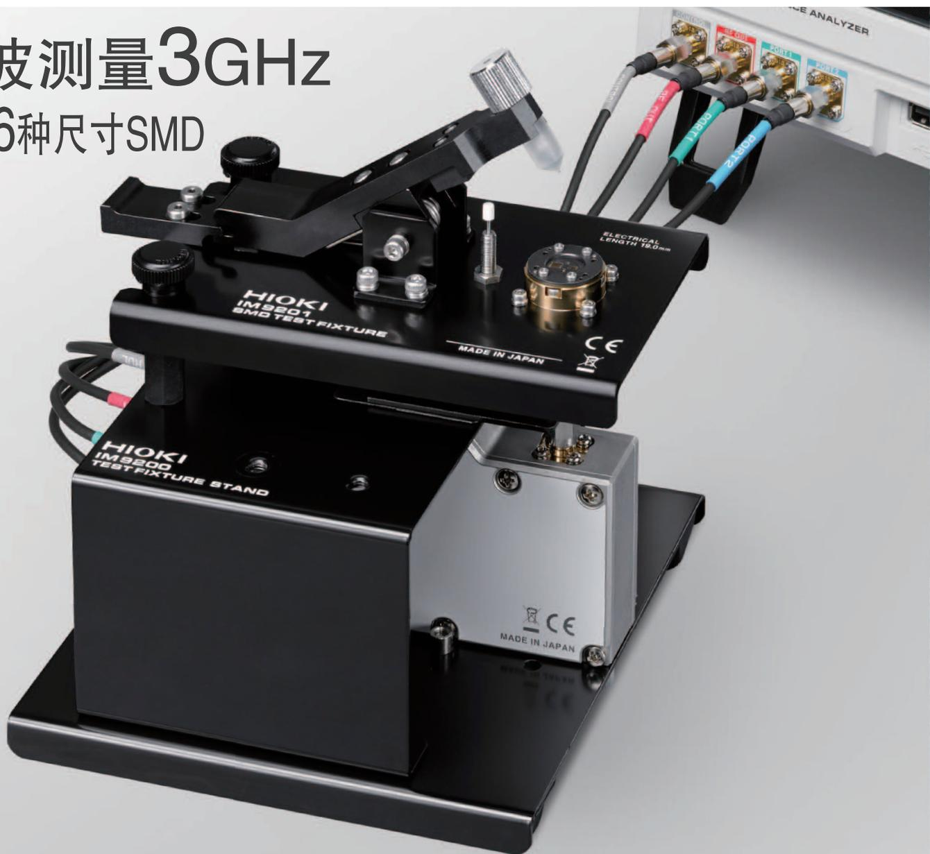
对应两种机械装置6种不同尺寸SMD
