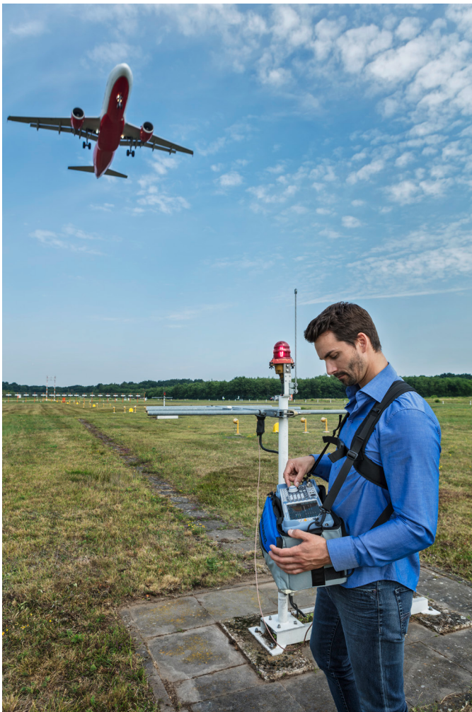
ILS measurements on ILS monitoring antenna
