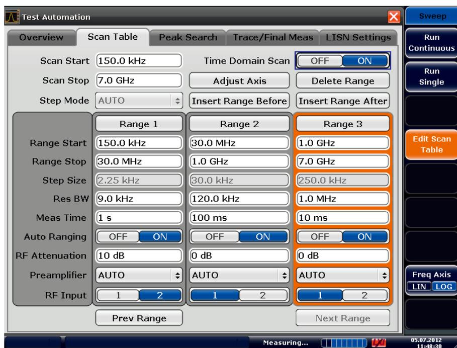
在 RECEIVER 接收机模式下可以根据扫描表中的设置调整R&S®ESR。用户可以定义十个频率范围，每个频率范围可独立设置的参数(开始/停止频率、步进、测量时间、分辨带宽、输入衰减等等)。
