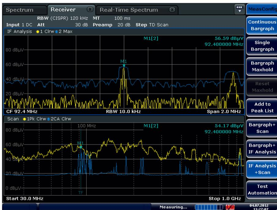
屏幕上方：使用中频分析功能，在当前EMI接收频率附近射频输入信号的连续频谱显示。
