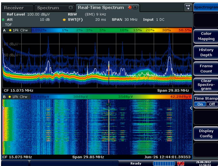
同时用余辉模式 (顶部) 和频谱图 (底部) 来显示干扰频谱。频谱图可在一段时间内连续提供有关被测设备 (DUT) 干扰行为的信息。在余辉模式下，用户可清晰区分窄带和宽带干扰。频谱图上用标识M1来指示用户选择的具体频谱中的时间位置 (频谱在余辉模式下显示为白色的迹线)，且可根据需要来定位M1。
