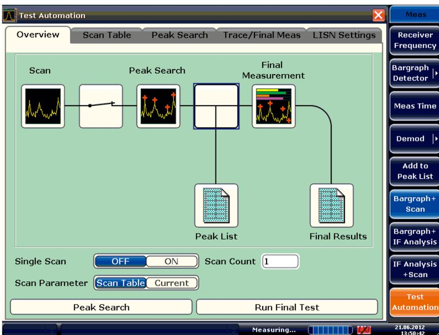
R&S® ESR 用户能够快速和方便地配置自动测试序列（预览测量/数据处理/最终测量），并按下按钮执行它们。最终测量也能采用交互方式执行。
