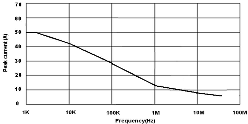
图 15 CP3050 最大峰值电流 VS 频率曲线
