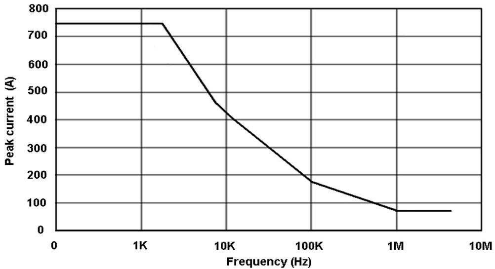
图 17 CP4040 最大峰值电流 VS 频率曲线
