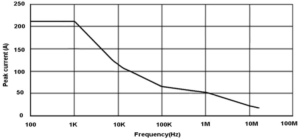
图 16 CP3030 最大峰值电流 VS 频率曲线
