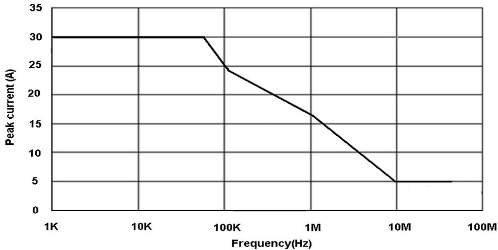
图 14 CP3120 最大峰值电流 VS 频率曲线
