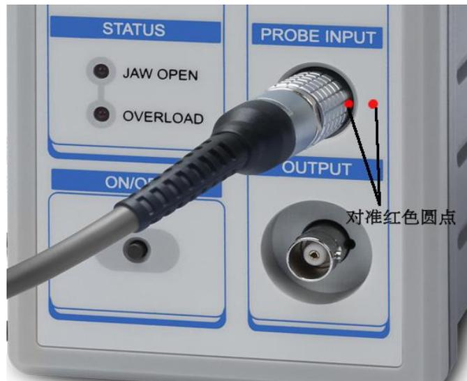
**注意：**拔出探头时，请先拉插头的套环，然后向后拔出探头，切不可直接用蛮力拔出探头，否则可能会拉断探头内部连线。
