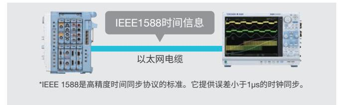
\*IEEE 1588是高精度时间同步协议的标准。它提供误差小于1μs的时钟同步。
