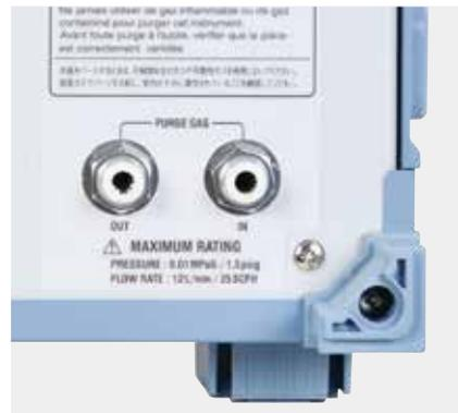
净化气体端口（输入和输出）
