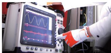
用于瞬态波形的观测、在无温度变化的场所进行短时间测量。
