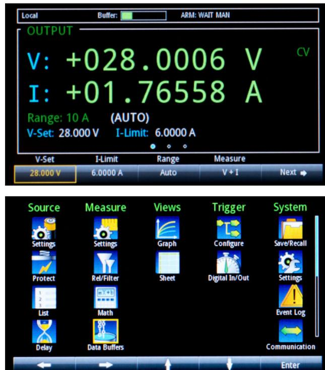
图3 通过主屏调整电压、电流、电流量程、测量模式、保护等级和其他功能。
