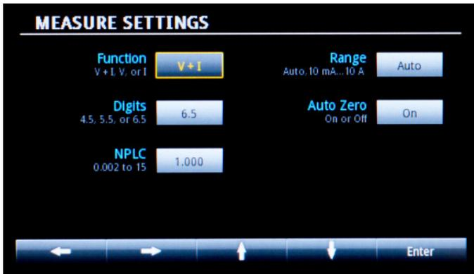
图5 通过测量子屏幕，根据用户对回读测量进行配置
